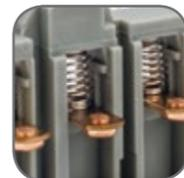
**Самопозиционирующиеся подвижные контакты.** Они могут качаться, подпружинены и имеют сферическую поверхность
